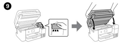
Continue to close the scanner unit even if you feel some resistance. / Continuez à fermer l'unité du scanner, même si vous sentez une résistance. / Schließen Sie die Scannereinheit auch, wenn Sie einen gewissen Widerstand spüren. / Ga door met sluiten van de scannereenheid, ook als u wat weerstand voelt. / Continuare a chiudere l'unità scanner anche se si avverte della resistenza. / Siga cerrando la unidad del escáner aunque encuentre algo de resistencia.
